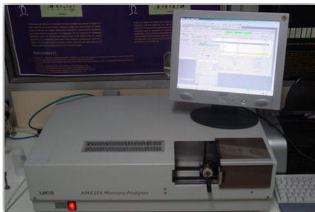
Figura Aparelho utilizado na determinação do mercúrio (Imagem gentilmente cedida pelo Laboratório Físico-Químico Sensorial do INRB, I.P./L-IPIMAR Lisboa).
