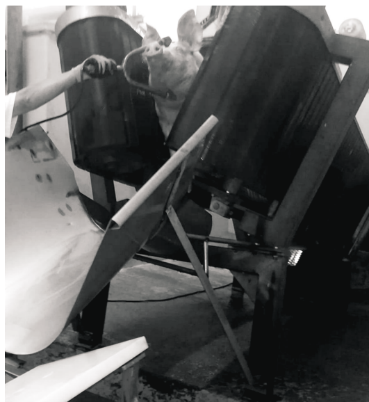
Figura 8 Atordoamento por electronarcose manual, em caso de falha do equipamento automático
